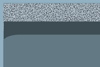
← Poröse Oxidschicht ← Umwandlungs-Oxidschicht ← Titanium
