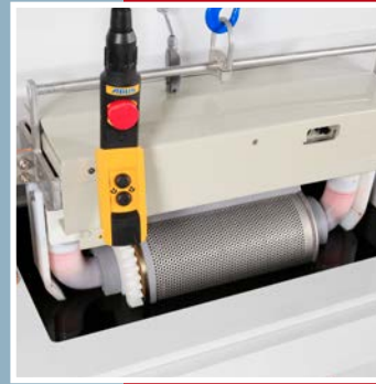
Elektropolieren von Kleinteilen als Schüttgut in Trommeln
