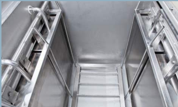
Tauchschwinger an Front- und Rückseite der Ultraschall-Reinigungswanne
