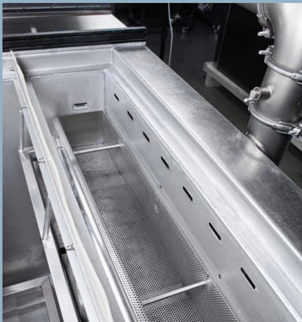
Überlauf tasche mit Grobfiltrierung und integrierter Absaugung
