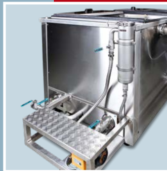
Filterkreislauf zur Erhöhung der Standzeit des Reinigungsmediums
