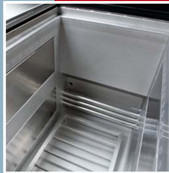
Platzsparend eingebaute Plattenschwinger, Heizung in Nischen
