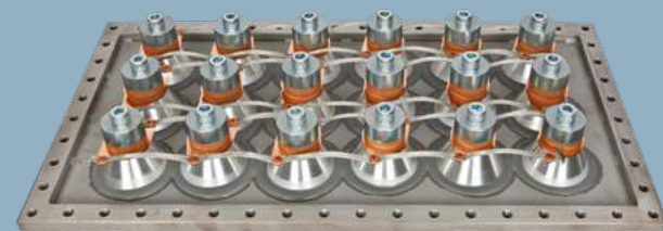
Plattenschwinger mit Anpressrahmen
