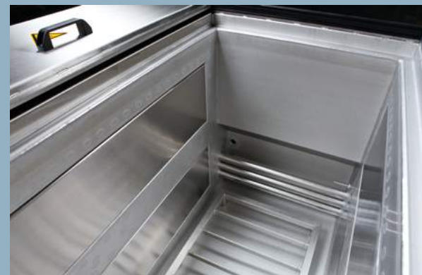
Innenansicht einer Wanne mit eingeflanschten Plattenschwingern
