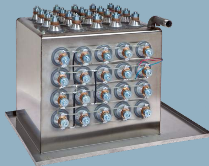
Ultraschallwanne bestückt mit Schwingelementen am Wannenboden und einer Längsseite
